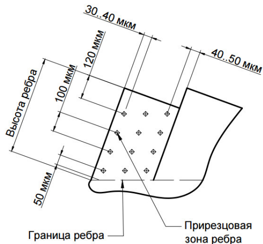
Рисунок 1. Схема измерения микротвердости
