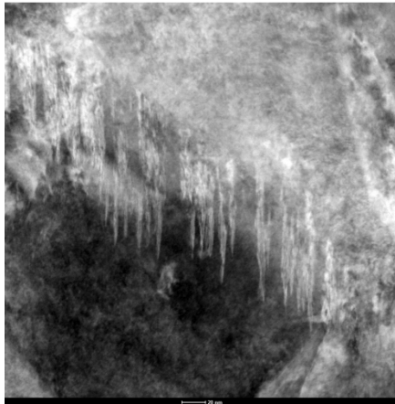
Рисунок 3. Нанопластины цементита в прирезцовой зоне ребра.
