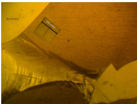
Рис. 3 Вид зоны разрушения пленки
