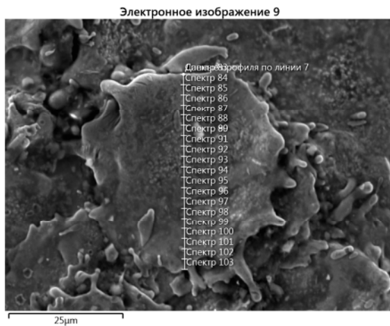
Рис. 1. Атомный состав зоны взрывного плавления (вертикальная линия сканирования).
