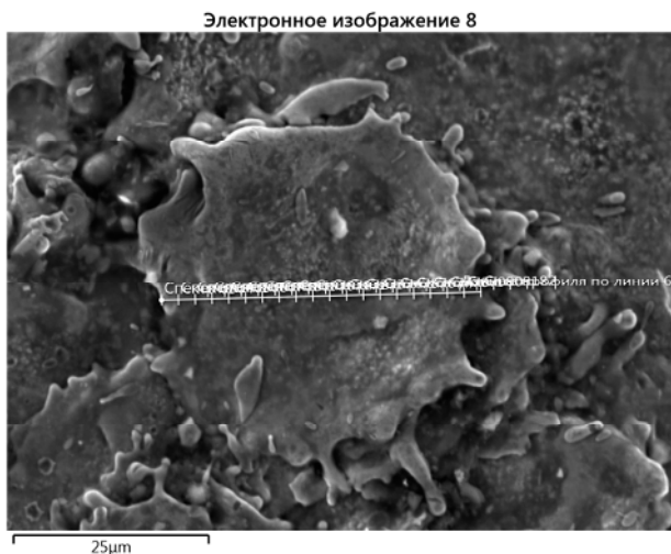
Рис. 2. Атомный состав зоны взрывного плавления (горизонтальная линия сканирования).
