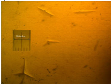
Рис. 2 Трещины в пленке в зоне вблизи зоны разрушения. На рисунке показан мерный отрезок – кусок шкалы объект-микрометра на отражение (ОМО)
