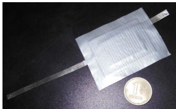
Рисунок 6 – Фотография лабораторного макета твердофазного короткозамкнутого ХИТ с пленочным катодом
