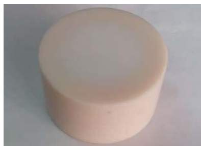
Рисунок 4 – Цилиндрический образец из радиационно-модифицированного фторопласта диаметром 60 мм
