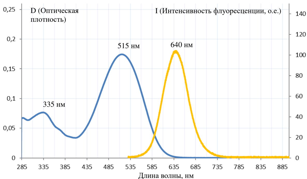
Рисунок 3 – Спектр LS-686 поглощения (1) в хлорбензоле с концентрацией 0,01 мг/мл (1) и флуоресценции (2) с концентрацией 0,005 мг/мл в хлорбензоле при длине волны возбуждающего излучения на 515 нм
