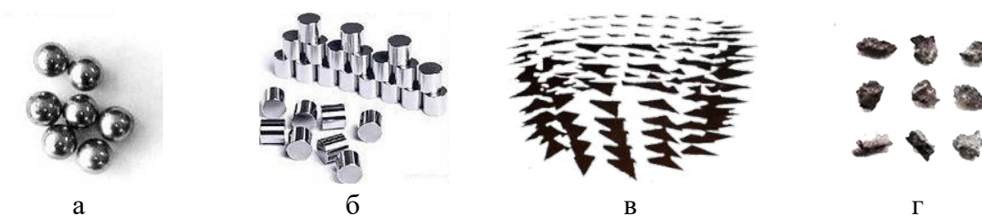
а - шарики; б - ролики; в – плоские режущие полуготовые элементы; г – осколки неправильной формы
